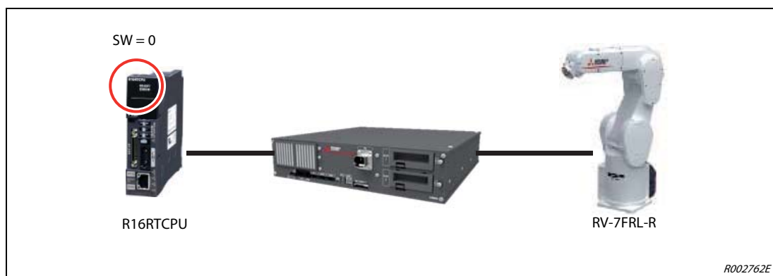
Abb. 5-7: Schließen Sie den Roboter an das Steuergerät CR800-R an
