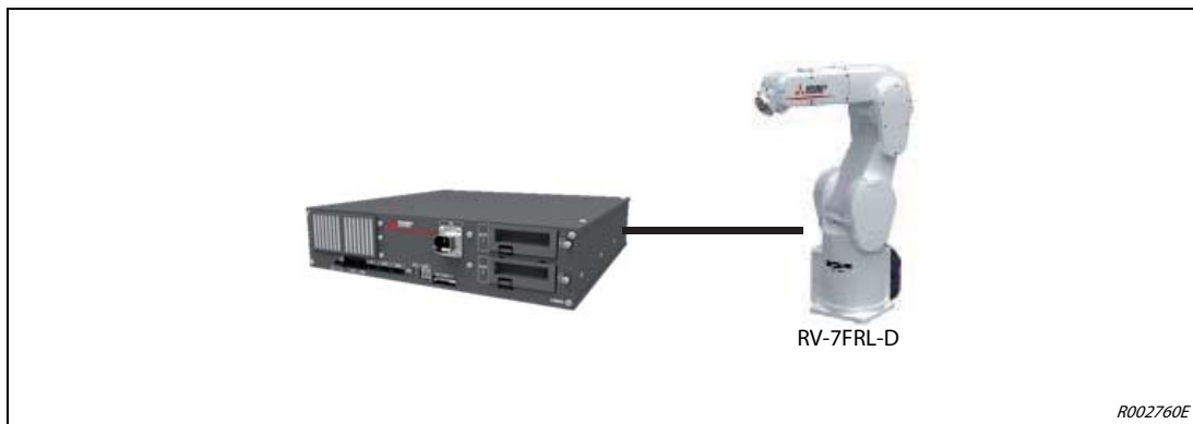
Abb. 5-3: Schließen Sie den Roboter an das Steuergerät CR800-D an
