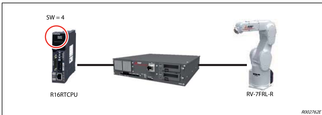
Abb. 5-5: Stellen Sie den Codierschalter SW auf 4
