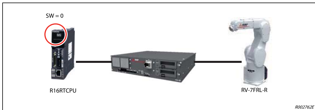
Abb. 5-6: Stellen Sie den Codierschalter SW auf 0
