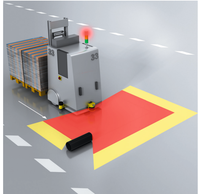
Abbildung 82: Positionierung eines Prüfkörpers an einem fahrerlosen Fahrzeug zur Prüfung der Detektion einer liegenden Person
