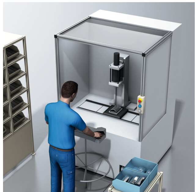
Abbildung 69: Beispiel der Anwendung einer Zweihandeinrichtung. Diese ist beweglich ausgeführt (Ergonomie). Ein Disanzring sichert die Einhaltung des Sicherheitsabstands zur Gefahrstelle.
