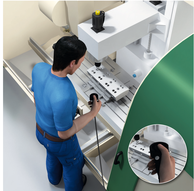
Abbildung 70: Zustimmeinrichtung zur Einrichtung eines Bohrautomaten
