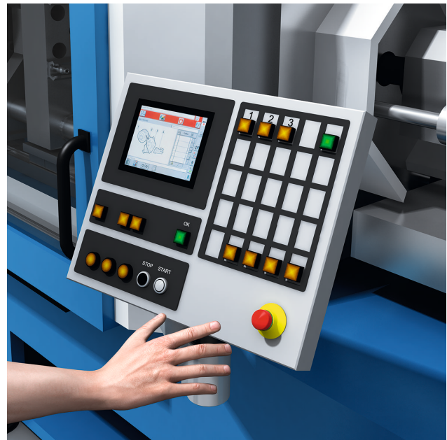
Abbildung 31: Stillsetzen im Notfall durch einen Not-Halt-Taster
