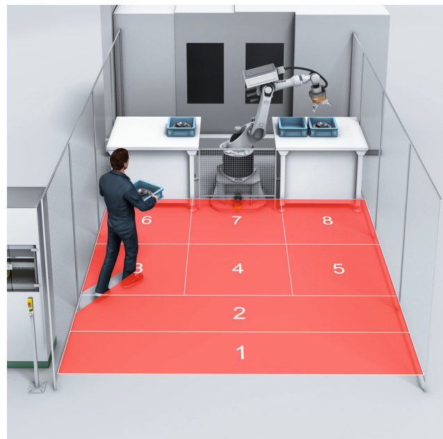
Abbildung 47: Simultane Überwachung mehrerer Schutzfelder
