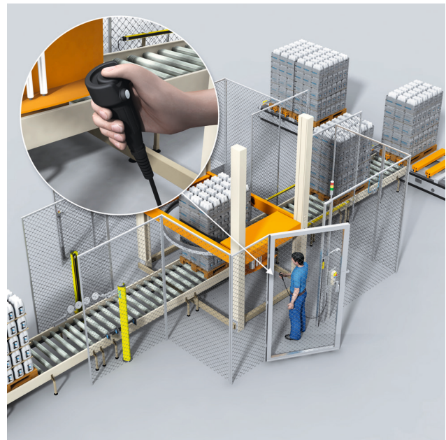
Abbildung 29: Sicheres Wechseln der Folienrolle an einer Folienwickelmaschine bei geöffneter Schutztür durch die Kombination von Zustimmungstaster und sicher reduzierter Geschwindigkeit
