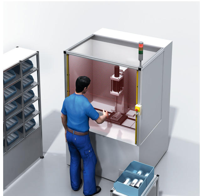
Abbildung 45: Gefahrstellenabsicherung mit einem Sicherheitslichtvorhang
