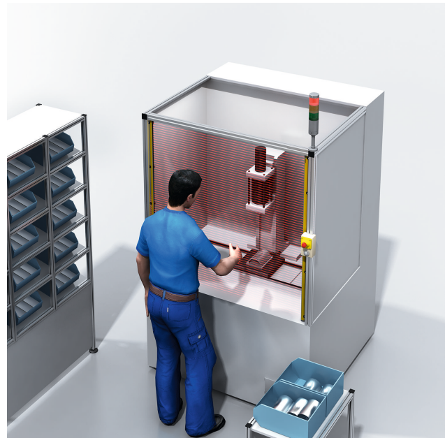
Abbildung 54: Gefahrstellenabsicherung an einem Montage-automat mit Sicherheitslichtvorhang
