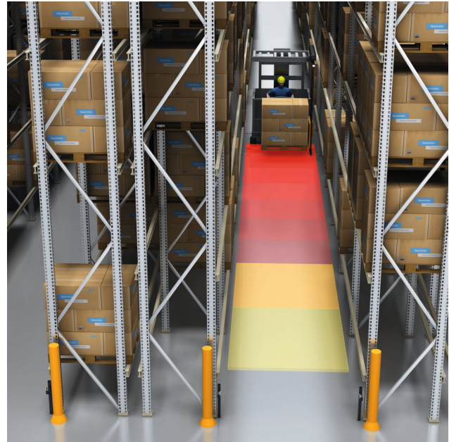
Abbildung 30: Anpassung des Überwachungsbereichs eines Sicherheitslaserscanners an die Fahrzeuggeschwindigkeit
