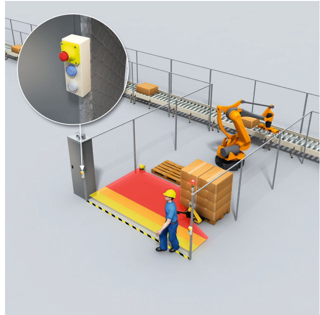
Abbildung 73: Not-Halt- und Reset-Befehlsgeräte an Roboterstation
