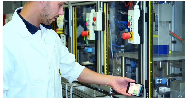
Abbildung 7: Absicherung einer Maschine und Diagnose der Schutzeinrichtung
