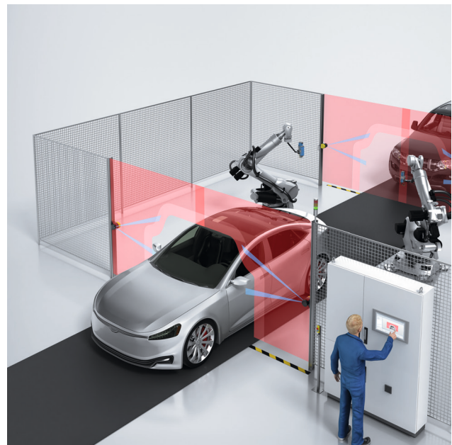
Abbildung 58: Anwendungsbeispiel für die Durchfahrt von Material mit unterschiedlicher Kontur und entsprechend automatisch angepassten Schutzfeldern von Sicherheitslaserscannern
