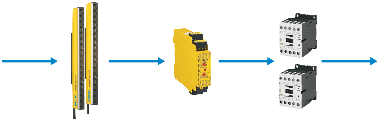
Abbildung 116: Teilsysteme in der Sicherheitskette: Sicherheitslichtvorhang, Logikeinheit, Schütze
