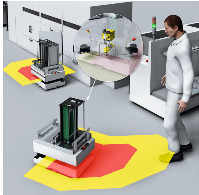
Abbildung 66: Anwendungsbeispiel für Schutzfelder an einem fahrerlosen Fahrzeug
