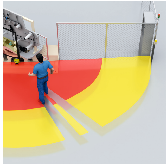
Abbildung 25: Stopp auslösen und Start verhindern durch einen Sicherheitslaserscanner (Gefahrenbereichsüberwachung)
