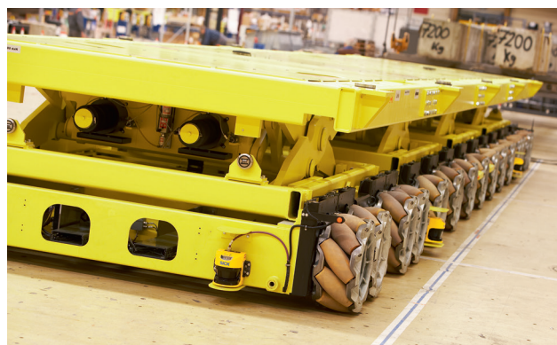
Abbildung 81: Gefahrbereichsabsicherung an einem fahrerlosen Fahrzeug mit Sicherheitslaserscannern
