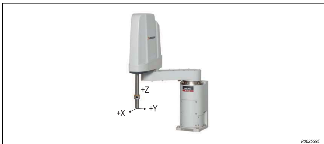
Abb. 9-21: Koordinatensystem für die Hand- und Werkstückbedingungen für SCARA-Roboter
