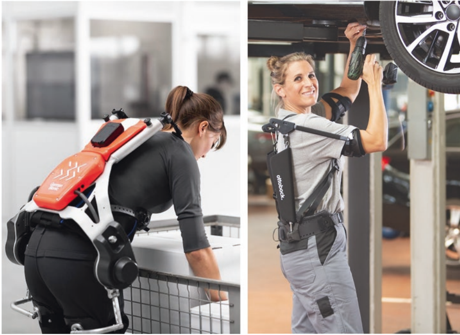
Abb. 1.11 Mensch-Roboter-Interaktion ganz nah am Menschen: Ergonomische Entlastung durch Exoskelette, Assistenten zum Anziehen. (Quellen German Bionic Systems, ottobock)
