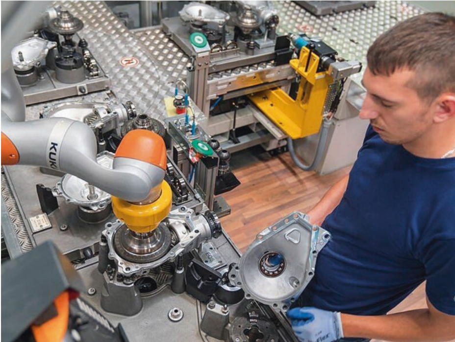
Abb. 12.3 Mensch-Roboter-Kollaboration in der Achsgetriebemontage im BMW-Werk Dingolfing. (Quelle: BMW Group)
