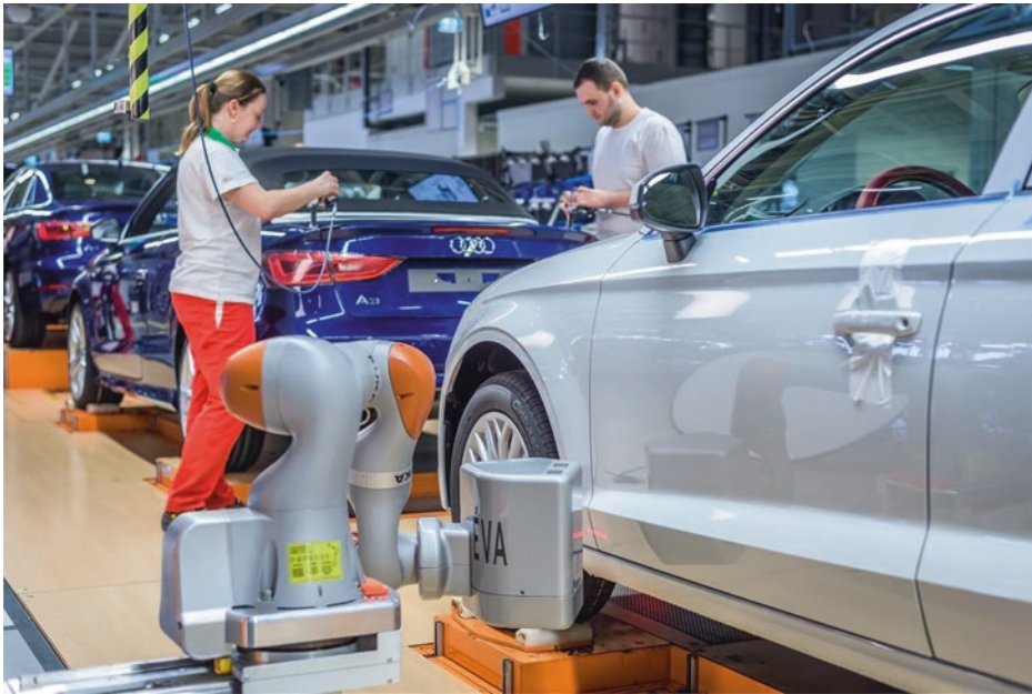
Abb. 5.4 MRK-Roboter Eva im Audi Produktionswerk Győr, Spaltmessung parallel zum Fertigungsfluss und dem Einsatz der Werker. (Quelle Audi)
