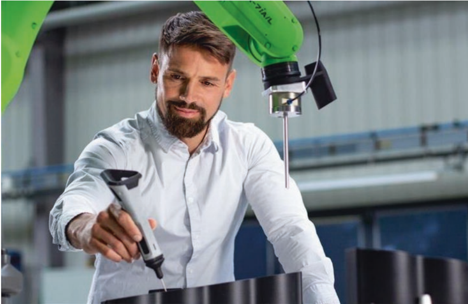
Abb. 7.5 Intuitive Roboterbedienung: Demonstrieren statt Programmieren. (Quelle Wandelbots)
