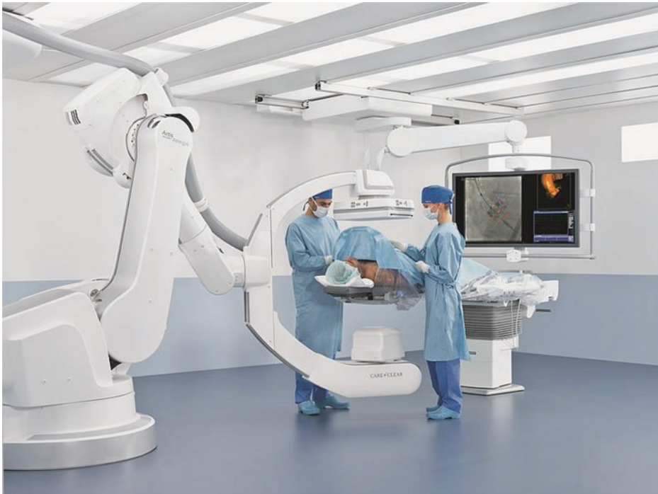
Abb. 15.6 Robotereinsatz zur Patientenlokalisierung und Computertomographie (CT) in offenen Systemen und roboterunterstützten Behandlungsräumen. (Quelle Kuka Roboter)
