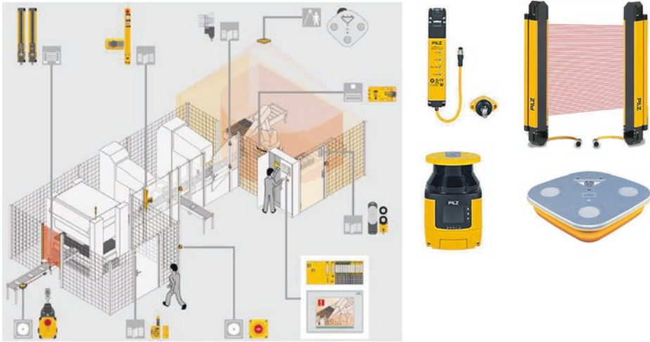
Abb. 10.4 Absicherung einer klassischen Roboterzelle durch trennende Schutzeinrichtungen. (Quelle Pilz)
