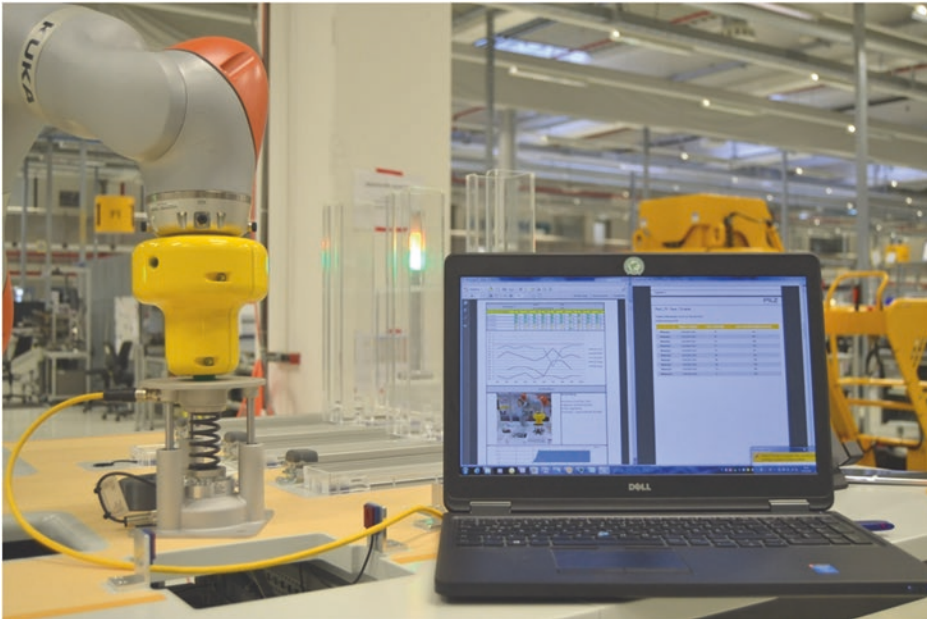
Abb. 11.1 Kraftmessung als Nachweis zur Einhaltung der biomechanischen Grenzwerte entsprechend ISO/TS 15066 – Anhang A und Dokumentation. (Quelle: Pilz)
