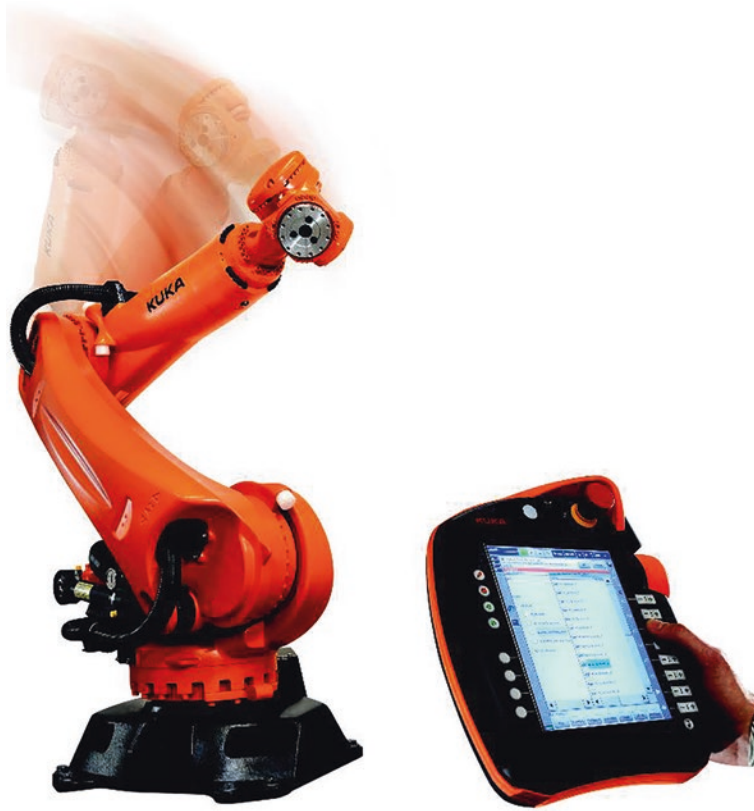
Abb. 1.2 Industrieroboter mit 6-achsiger Knickarmkinematik und Handbediengerät. (Quelle Kuka Roboter)
