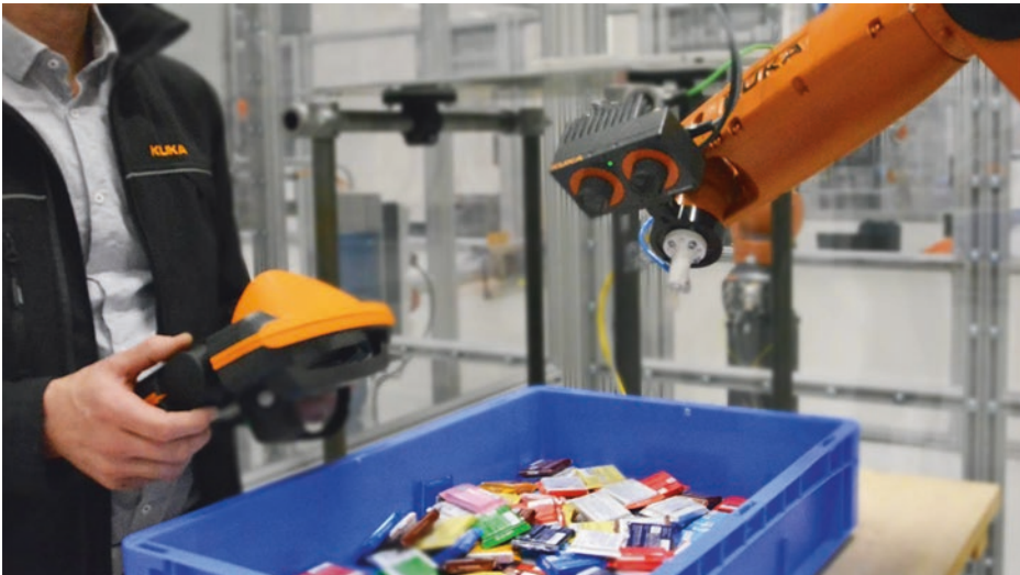
Abb. 15.3 Kameragestütztes Bin-Picking aus Logistikbehältnissen. (Quelle Kuka Roboter)
