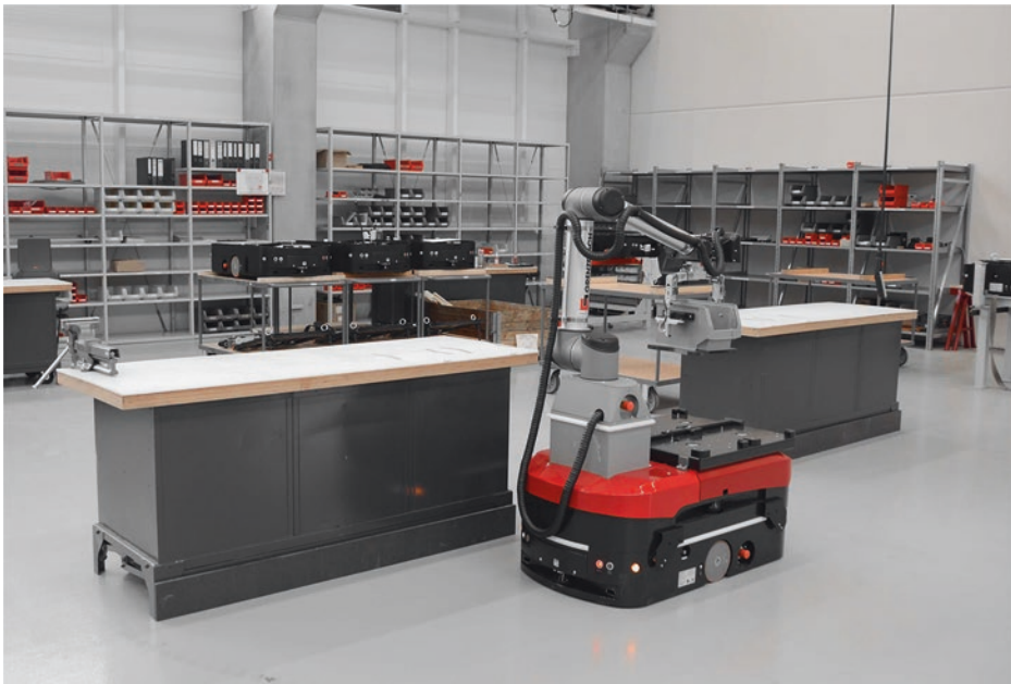
Abb. 15.4 Mobile Roboter und Transportsysteme unterstützen Werker am Arbeitsplatz und bei der innerbetrieblichen Logistik. MRK-Herausforderung auf Fahrten! (Quelle Grenzebach)
