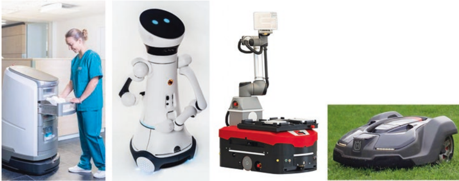
Abb. 1.9 Mobile Serviceroboter für Gastronomie, Gesundheitswesen, Logistik und Garten, die mit den Menschen und ihrer Umgebung interagieren. (Quellen Robotise, Care-o-Bot, Grenzbach, Husquarna)
