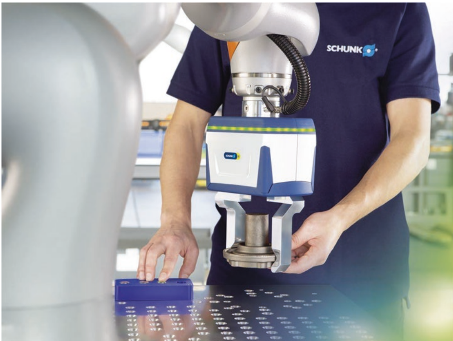
Abb. 12.5 Handhabung und Einbau von Getriebekomponenten mit einem MRK-fähigen Greifer, der die Einhaltung der Kraftgrenzen auch bei größeren Traglasten aktiv überwacht. (Quelle: Schunk)
